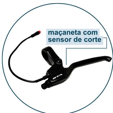
Quando isso é feito, ele imediatamente corta a energia que está sendo fornecida ao motor, interrompendo assim a aceleração/**funcionamento** do Kit Elétrico de forma rápida e eficaz. Isso é crucial para a segurança, especialmente em situações de emergência onde uma parada rápida é necessária.
